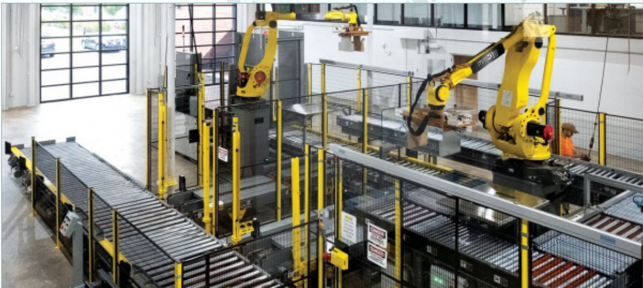
그림 15. 타이슨 자동화센터에 설치된 박스 포장 로봇
