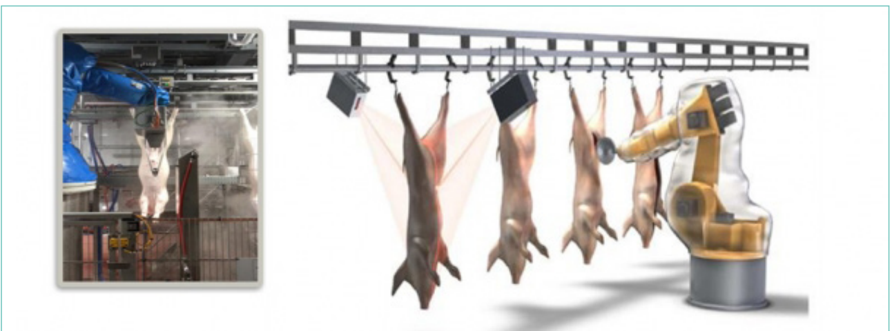
그림 13. 개복작업과 이분체 라인에 설치한 로봇
