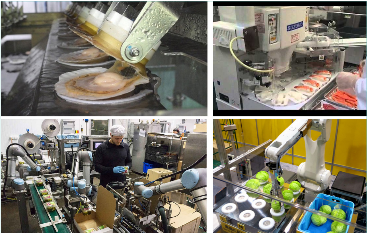
그림 7. 가리비 가공, 초밥 생산, 도시락 포장, 양배추 선별 등 식품 제조업에서 로봇의 활용
