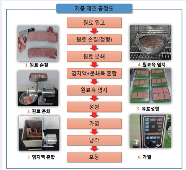
그림 3. 습식육포의 제조 공정
