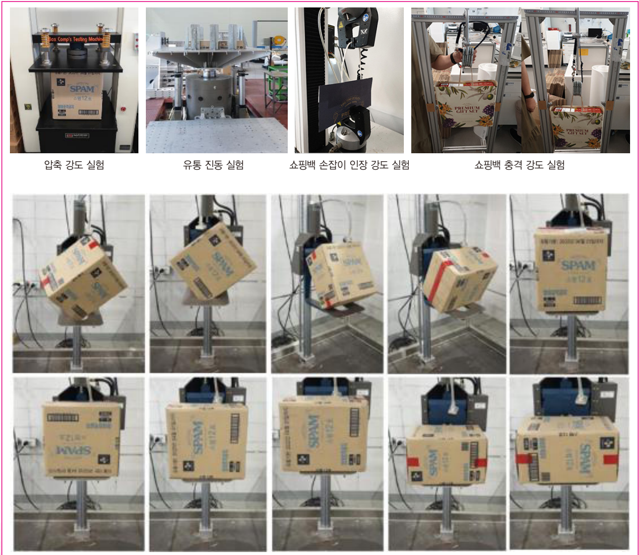
그림 11. 박스 낙하 충격 강도 실험(Corner 1, Edges 3, Face 6)
